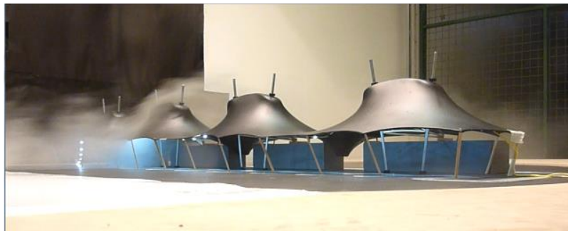
Figura 9. Visualización con humo, vista inferior.
