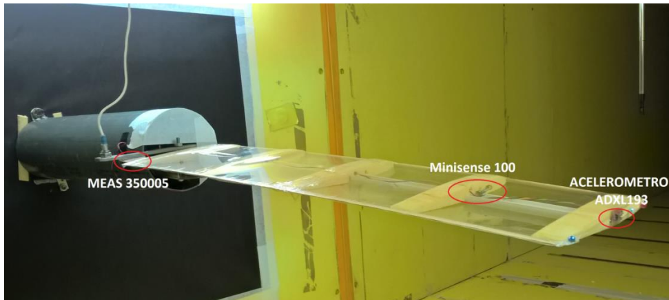
Figura 4. Montaje en túnel del modelo
