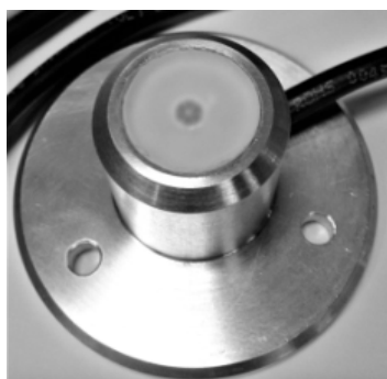
Figura 7: Radiómetro global desarrollado en el DES.
