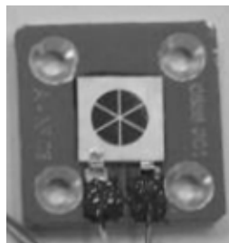
Figura 5: Sensor grueso de posición de ingeniería de la misión SAOCOM desarrollado en el DES.
