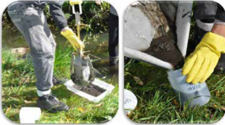
FIGURA 2. EJEMPLO DE TOMA DE MUESTRAS DE SEDIMENTO CON UNA DRAGA EKMAN Y GUARDADO PARA SU CONSERVACIÓN CON FORMALDEHÍDO AL 4% EN FRASCOS ROTULADOS.
