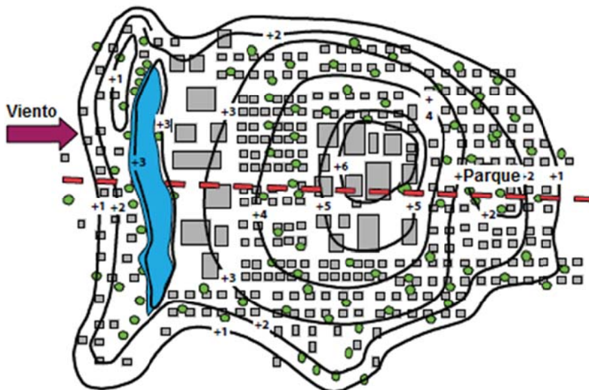
Figura 2. ICU atmosférica durante la noche, totalmente desarrollada. La línea roja indica el eje en el que fueron registradas las temperaturas. La temperatura del aire normalmente se mide a través de una densa red de puntos de muestreo, sean estaciones fijas o móviles (Fuente: Adaptado de EPA 2008).
