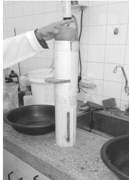
Figura 1: Dispositivo cilíndrico utilizado para la determinación de volumen de cáscara de maní.
