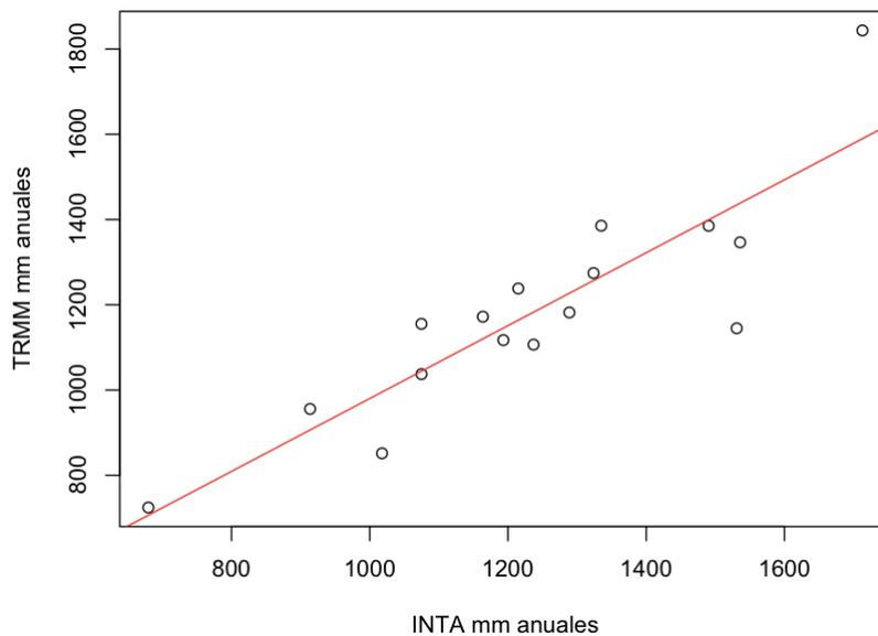
Figura 6. Diagrama de dispersión de la precipitación anual estimada por TRMM versus la medida en la E.E.A. INTA Paraná ( $R^2=0,767$ ) y medidas de ajuste de la regresión lineal entre TRMM e INTA para valores anuales.
