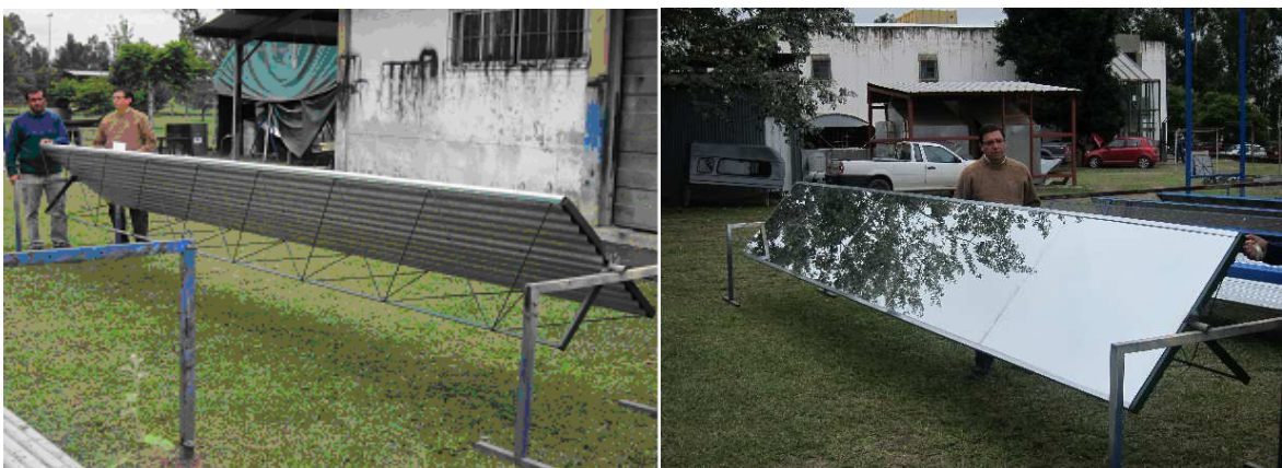
Figura 4.a y 4.b. Muestran la construcción de los espejos reflectores y su estructura de soporte
