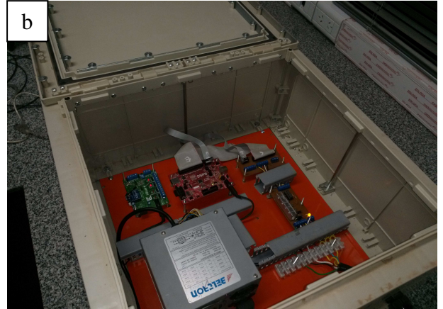
Fig. 12a.-El motor paso a paso que proporciona el giro a las filas de espejos y la caja azul de demultiplicación Fig. 12b.-Gabinete con los elementos electrónicos utilizados para comandar los motores.
