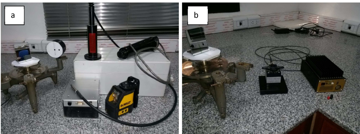
Figura 1. Instrumental utilizado para las mediciones de reflectancia de espejos, a) para la etapa 1 y b) para la 2da etapa.
