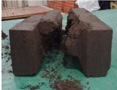
Fig. 10. Rotura longitudinal del BTC
