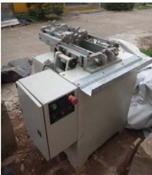
Fig. 3. Prensa electromecánica
