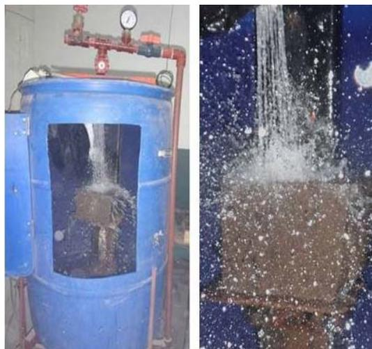
Fig 9. Ensayo de erosión húmeda
