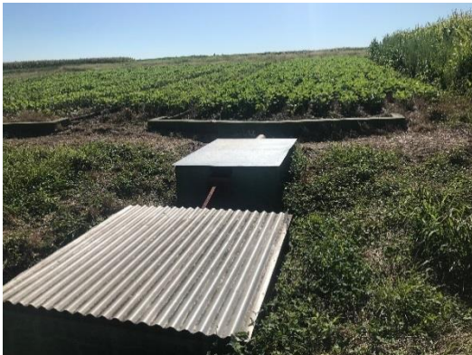
Figura 2. Colectores de agua y suelo en una de las parcelas de escorrentía.
