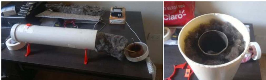
Figura 13: Equipo de medición de transmisión de calor en régimen estacionario con la muestra de lana cardada en su interior.
