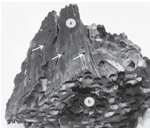
Figura 2. Trozo de pilote sumergido en la costa de Patagonia (Argentina), a: zona de ingreso del molusco perforador Teredo sp., las flechas indican los orificios de ingreso de las larvas del molusco, b: corte transversal de la madera del pilote.
