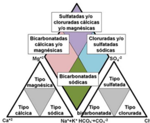
FIGURA 2. DIAGRAMA DE PIPER. PERMITE ANALIZAR GRÁFICAMENTE LA COMPOSICIÓN QUÍMICA DEL AGUA. LAS MUESTRAS QUE POSEEN CONSTITUCIÓN GEOQUÍMICA SIMILAR SE AGRUPAN EN ÁREAS DEFINIDAS.
