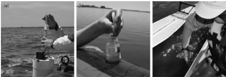
FIGURA 2. a) TOMA DE MUESTRAS DE AIRE DURANTE LA CÁMARA ESTÁTICA, b) MUESTRAS DE AGUA PARA LA MEDICIÓN DE LA CONCENTRACIÓN DE \text{CH}_4 DISUELTO, c) ECOSONDA PORTABLE PARA LA MEDICIÓN DE LA PROFUNDIDAD DE LA LAGUNA (FOTOGRAFÍA C: SCOUTS DE LA CIENCIA, 2015).
