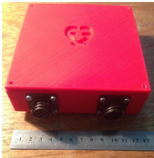
Fig. 1. Vista superior del equipo y referencia de escala. Puede verse en la imagen que el gabinete del equipo es de tamaño reducido. El equipo cuenta con dos conectores de cuatro terminales roscados de alta calidad.
