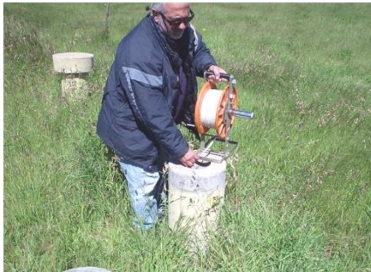
Figura 3. Medición del nivel freático.
