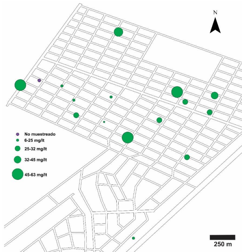
Figura 2. Resultados de contenido de nitrato en las muestras, considerando los 5 puntos remuestreados.
