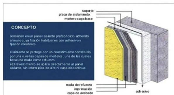
Figura N/18: Dibujo conceptual del sistema de aislamiento térmico exterior en muros y tabiques -EIFS.
