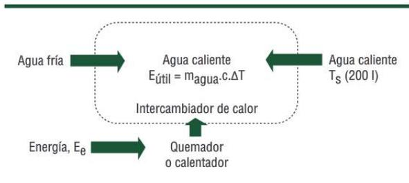
Figura N/43: Diagrama esquemático de los sistemas de calentamiento de agua. Consumo residencial medio total, incluyendo la fracción de energía que se consume como gas y electricidad respectivamente. Fuente elaboración propia.
