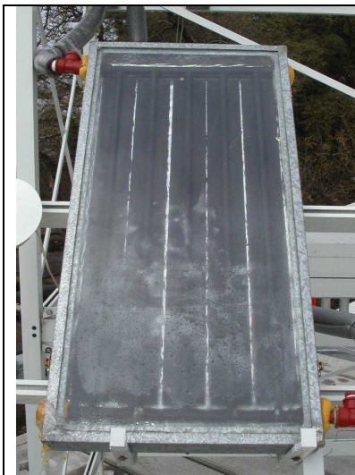
Figura 1: Sistema utilizando placa absorbidora de Hidrobronz.
