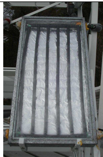
Figura 3: Sistema utilizando placa absorbidora de Caños de polietileno de 3/4”
