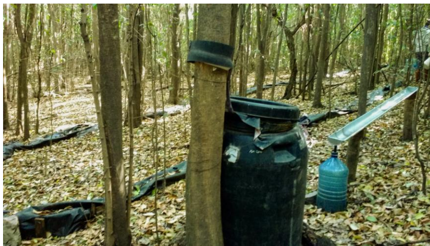
Fig. 3.2. Colector de metal tipo canal de la precipitación directa con su reservorio de 20 L y colector anular de la precipitación fustal con su reservorio de 200 L.
