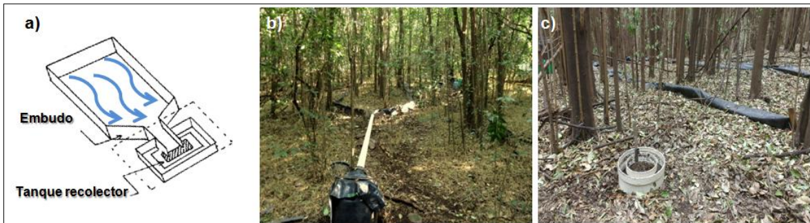
Fig. 4.1. (a) Modelo de parcela de escorrentía, (b) tanque recolector de agua escurrida, e (c) infiltrómetro de doble anillo para la determinación de la conductividad hidráulica saturada en un parche de bosque de Ligustrum .
