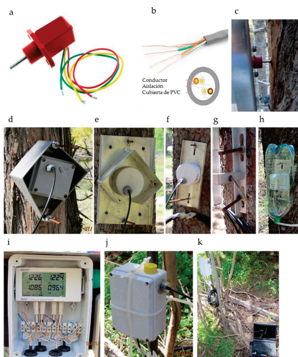
Figura 1. Imágenes de los distintos componentes de los dendrómetros de punto: a) Potenciómetro de desplazamiento lineal; b) Cable telefónico para intemperie de 4 conductores (se usan sólo 3 en la conexión del potenciómetro con el registrador); c) Émbolo del potenciómetro en contacto con el fuste, d y e) Soporte de aluminio al fuste del árbol de los potenciómetros, que hace las veces de protector; f) Soporte de aluminio tipo perfil U; g) soporte de aluminio tipo perfil L; h) protección del dendrómetro mediante botella de plástico; i) Registrador de datos con peine de conexión y fichas estéreo plug 2.5 mm; j) Caja estanca con acceso al registrador mediante tapón plástico roscado; k) Conexión directa entre registrador y ordenador portátil a través de cable de conexión USB - mini USB.
