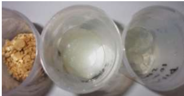
Figura 1: (de izquierda a derecha) Pulpas obtenidas luego del blanqueo, oxidación TEMPO y homogeneización.
