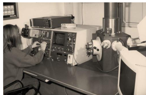
Figura 10. Microscopio Philips SEM 500, con una resolución de 10 nm.
