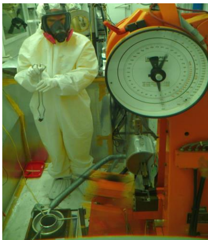
Figura 23. Ensayos de Charpy en Celda Caliente
