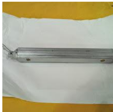
Figura 24. Dispositivo desarrollado para irradiar las probetas para ensayos SPT
