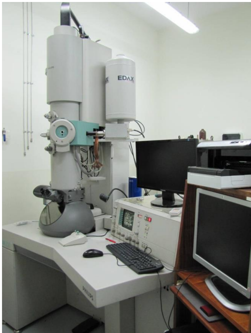
Figura 11. Microscopio Electrónico por Transmisión FEI CM200 con un sistema de microanálisis de EDX.
