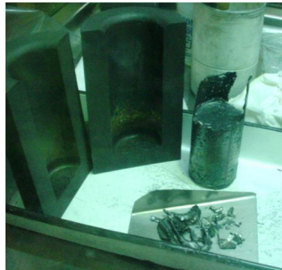
Figura 18. Lingote de U_3Si_2 (2.5 kg)
