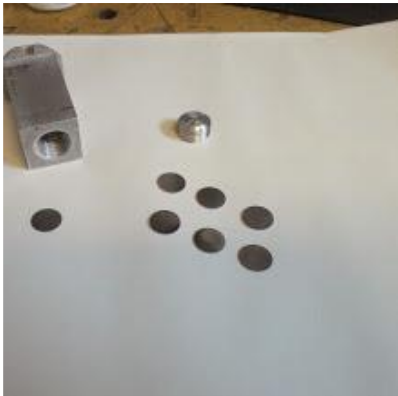
Figura 25. Mini Probetas de material de RP para evaluar cambios en las propiedades mecánicas por la irradiación utilizando la técnica SPT
