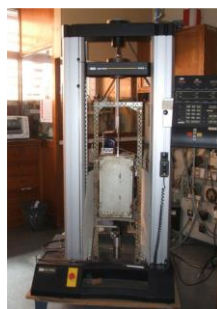
Figura 26. Máquina de tracción universal Instron, con un sistema de tracción invertido.
