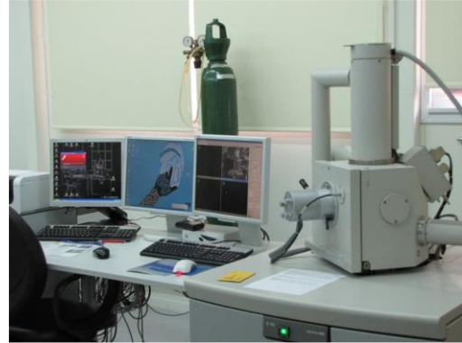
Figura 12. Microscopio Philips Quanta 200, con una resolución de 5 nm, y un sistema de microanálisis EDX.
