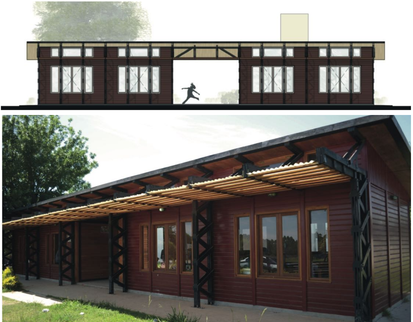
Figura 4. Diseño y desarrollo tecnológico de un SUM con madera local. Fuente: Imágenes extraídas de PID 0079 (2016).
