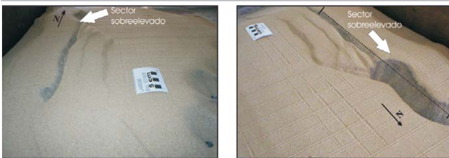
Figura 7: Distintas vistas del modelo deformado. Se indica el sector sobreelevado, coincidente con la intersección entre los dos trenes estructurales principales (Fig. 6). En la fotografía de la derecha se muestra la posición del corte de la figura 10a.
