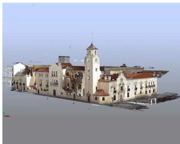
Figuras 1 y 2: Relevamiento inicial del Colegio Nacional de Monserrat mediante nube de puntos. Fuente: Captura de imagen en el espacio de trabajo del software SCENE®, 2016.
