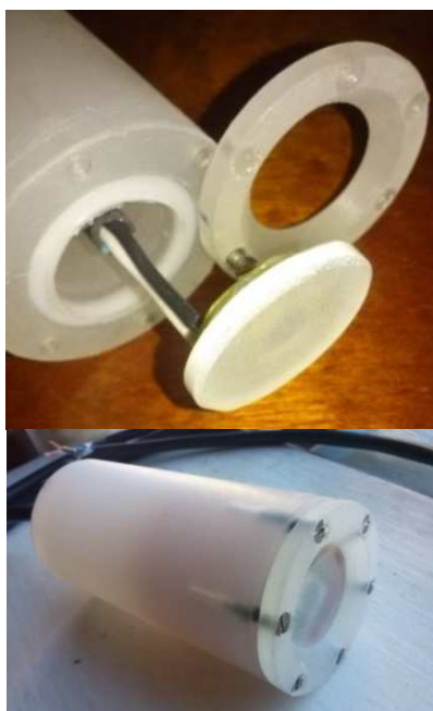
Fig.5: Imágenes del radiómetro en proceso de armado (superior) y terminado (inferior).
