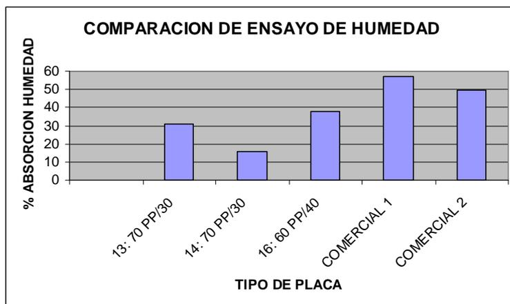
Gráfico IV. Comparación del porcentaje de absorción de humedad entre las placas de laboratorio y las placas comerciales de espesores similares.
