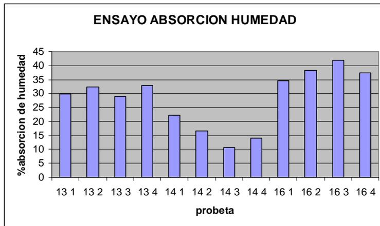
Gráfico III. Resultados del ensayo de absorción de humedad.
