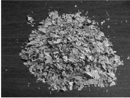
Figura 2. Polipropileno recuperado (film molido)
