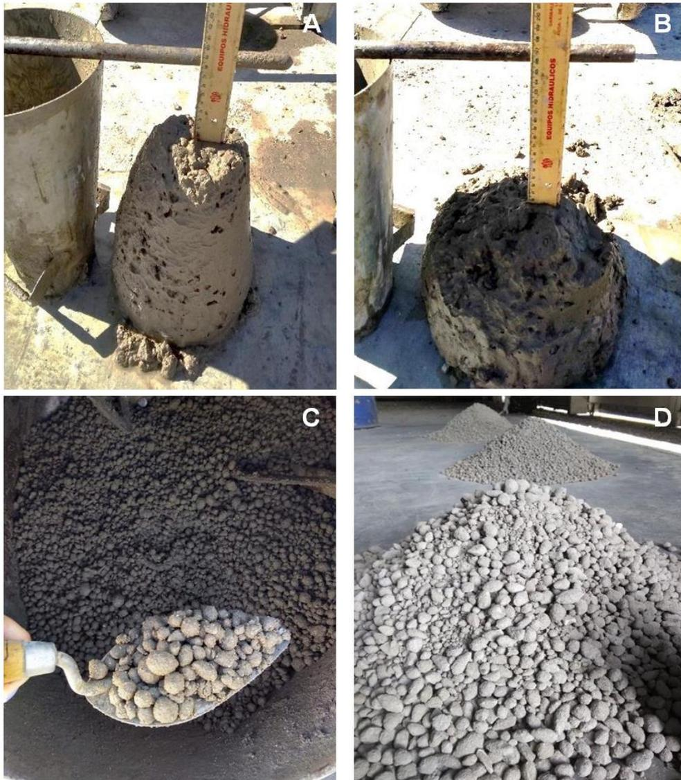
**Figura 3.** Proceso de conformado de los agregados pelletizados. a) Asentamiento inicial; b) asentamiento con la incorporación de superfluidificante; c) inmediatamente después del granulado; d) 24 horas después del granulado.
