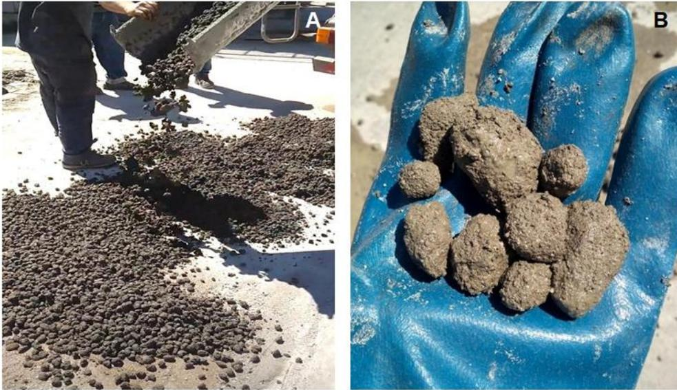
**Figura 8.** a) Descarga de AP desde camión moto-hormigonero. b) AP obtenidos de prueba en mixer.
