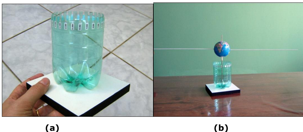
Figura 6: Em (a), garrafa recortada com sulcos usada como suporte; em (b), posição da Terra no suporte.
