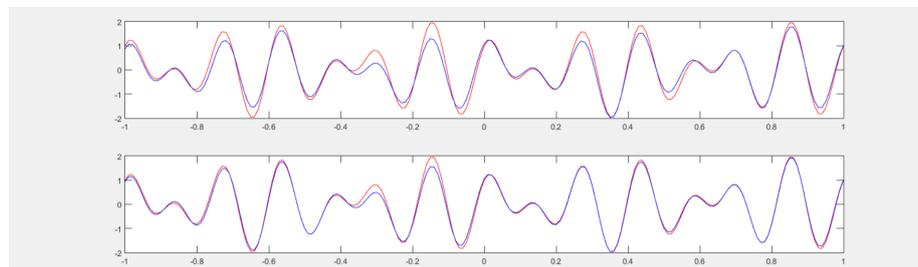
Figura 2: Señal original  $f$  en rojo, señales recuperadas  $f_3$  y  $f_6$  en azul, para  $\lambda = 20$
