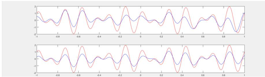
Figura 1: Señal original  $f$  en rojo, señal recuperada  $S_\lambda(f)$  en azul, para  $\lambda = 20, 100$
