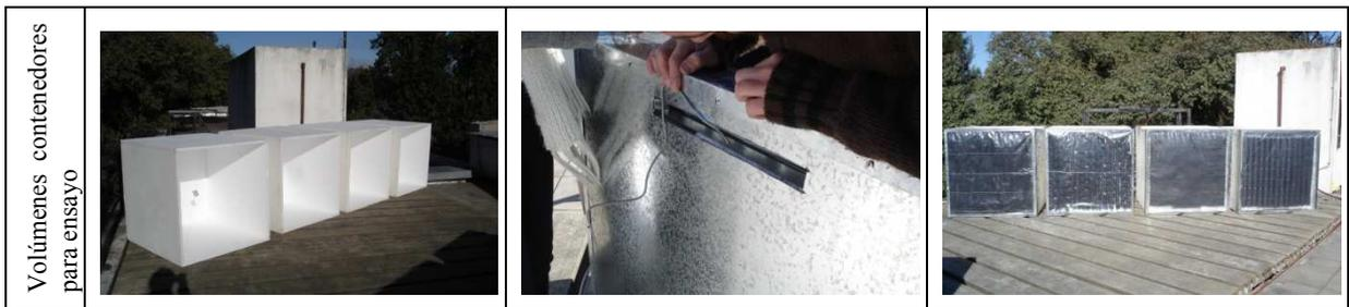
Figura 3. Montaje de las cajas para la medición de las seis probetas
