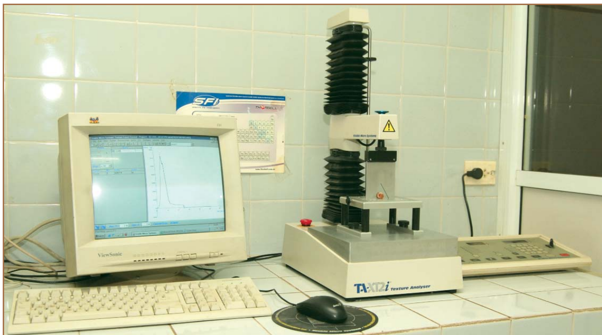
Texturómetro con celda Warner-Braztler
