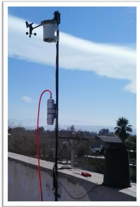
**Figura 6:** Estación meteorológica marca Davis que consta de pluviómetro, termómetros y anemómetros. Instalada en la Facultad de Ingeniería para el primer muestreo y posteriormente trasladada al sitio donde se realizó el segundo muestreo, en el Departamento de Chimbas, San Juan.
