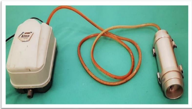
**Figura 4:** Kit completo de medición de PM. Constituido por el muestreador y un tubo conductor de plástico para conectar el muestreador y el aireador. El dispositivo debe conectarse a la red eléctrica domiciliaria para funcionar.
