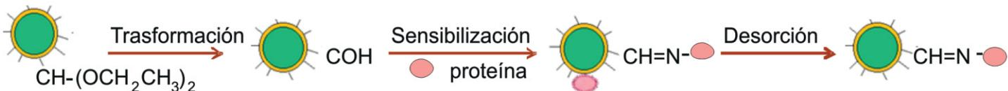
Fig. 3: Esquema del proceso de sensibilización por unión covalente de proteínas antigénicas sobre partículas de látex con funcionalidades carboxilo y acetal.
