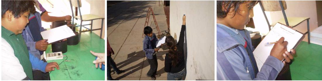
Figura 4: Medición de radiación solar con solarímetro y llenado de datos en planillas.
