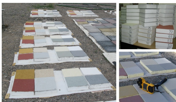
Figura 2. Evaluación térmica y óptica de los materiales en el predio.
