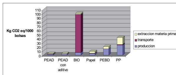
**Figura 3:** Potencial de calentamiento global para distintos tipos de bolsas y para cada etapa del ciclo de vida
