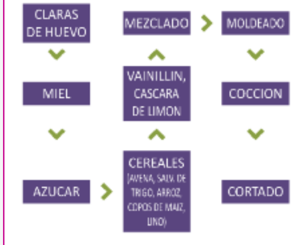
Figura 2: Diagrama de flujo del proceso de elaboración. Barras de cereal con lino
