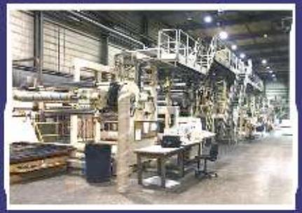
Coucheuse BMB construite en 1990 utilisée pour la fabrication de papier CB et CFB, Laize maximum 2 m, vitesse maximum: 1000 m/min, Plage de grammages: 40 à 170 g/m
