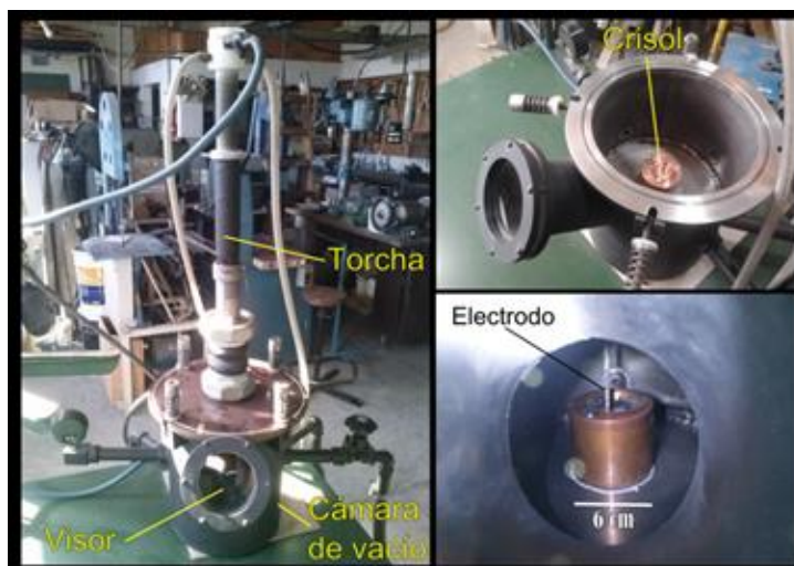
Fig. 1: Horno de arco utilizado en este trabajo. Pueden verse indicados algunos de los componentes principales
