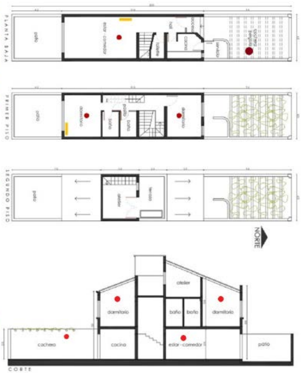
Figuras 3, 4, 5a y 5b. Fotografías de la vivienda caso de estudio. Plantas y corte. Ubicación de sensores en color rojo y esquema de circulación de aire en azul. Fuente: Andreoni Trentacoste, 2014.
