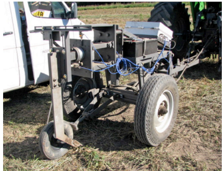
Fig. 2. Detalle del equipo de medición empleado. El ensamble permite que la púa trabaje con un ángulo de inclinación de 45°.
