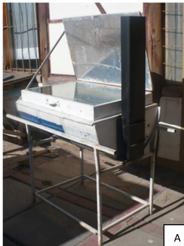
A) Horno híbrido solar – biomasa
