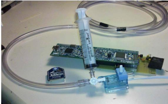
Figura 4. Nuevo prototipo portable en funcionamiento con un sensor de presión de columna de fluido.
