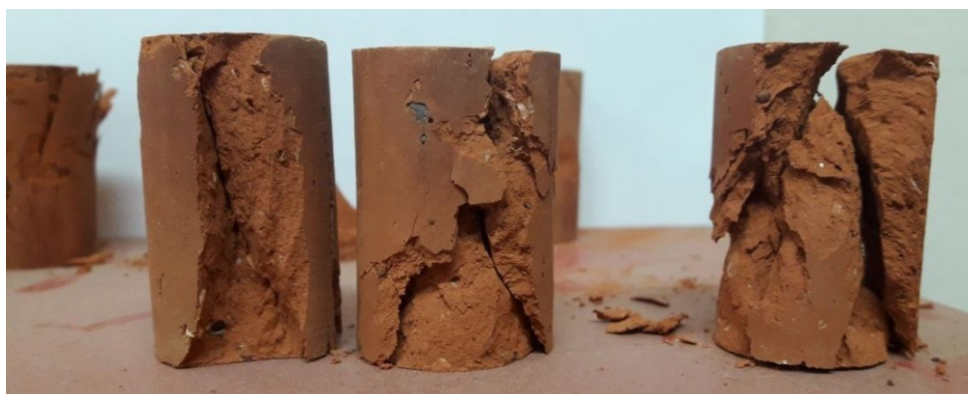
Figura11 Trayectoria de las fisuras en probetas de cerámica.
