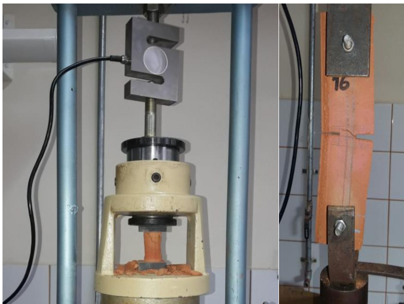
Figura 2. Ejemplos de ensayos de resistencia a Compresión/Tracción en probetas de cerámica.
