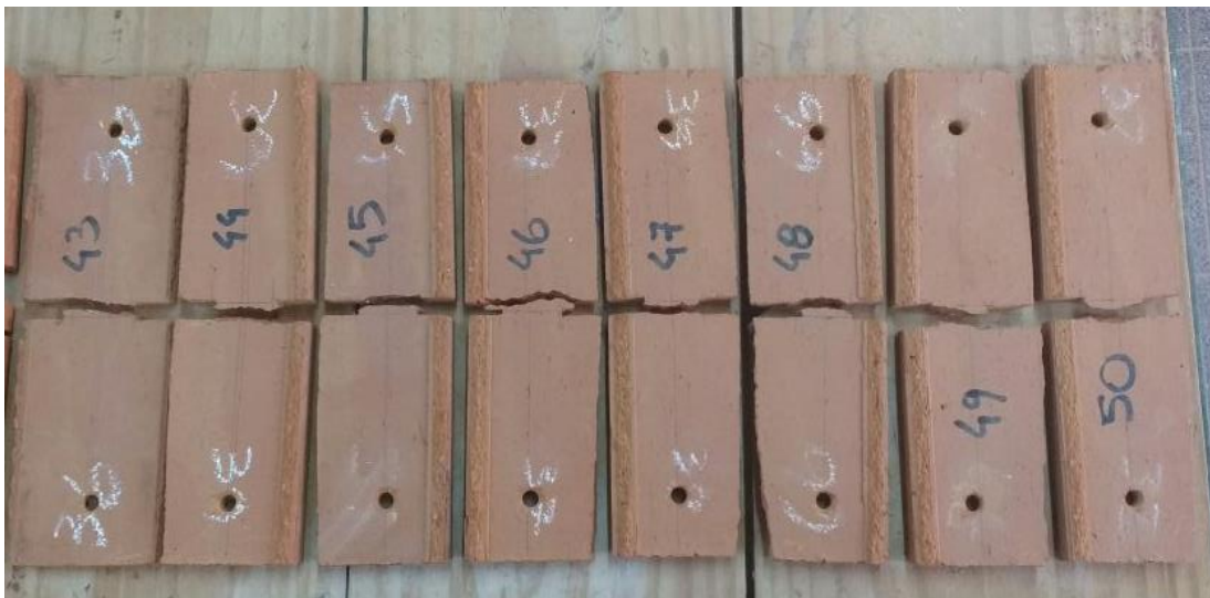
Figura 7 Probetas ensayadas a tracción.
