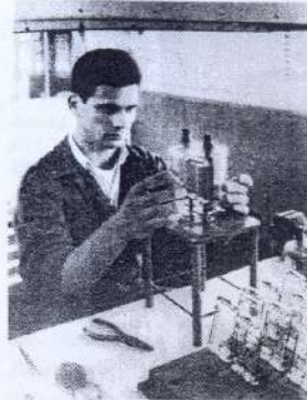
Fig. 38. Assembling an 833 in the F. A. P. E. S. A. plant.
