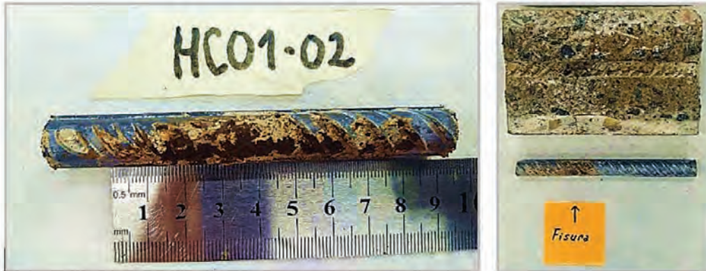
Figura 4: Deterioro en zona de fisuras en HC (izquierda) y en HRF (derecha).
