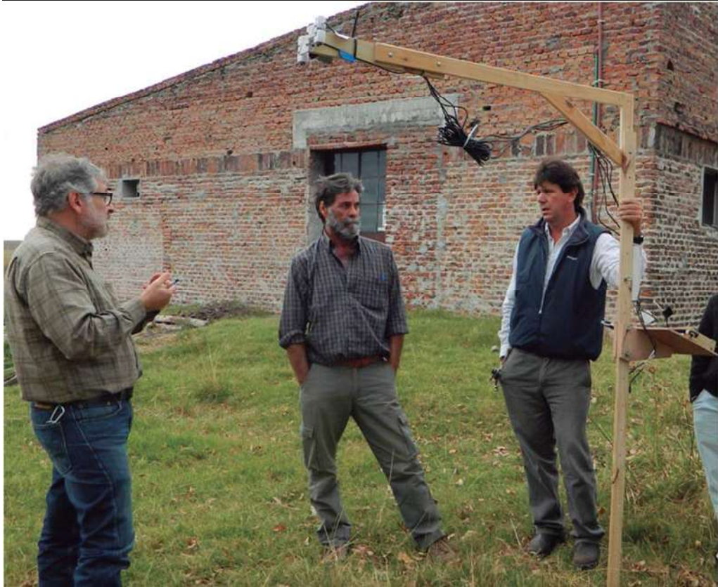
Figura 2. Soporte en forma de «L», con los cuatro sensores Decagon en un extremo, que permitieron medir la radiación en cuatro longitudes de onda en un área de aproximadamente 1,5 m 2 .
